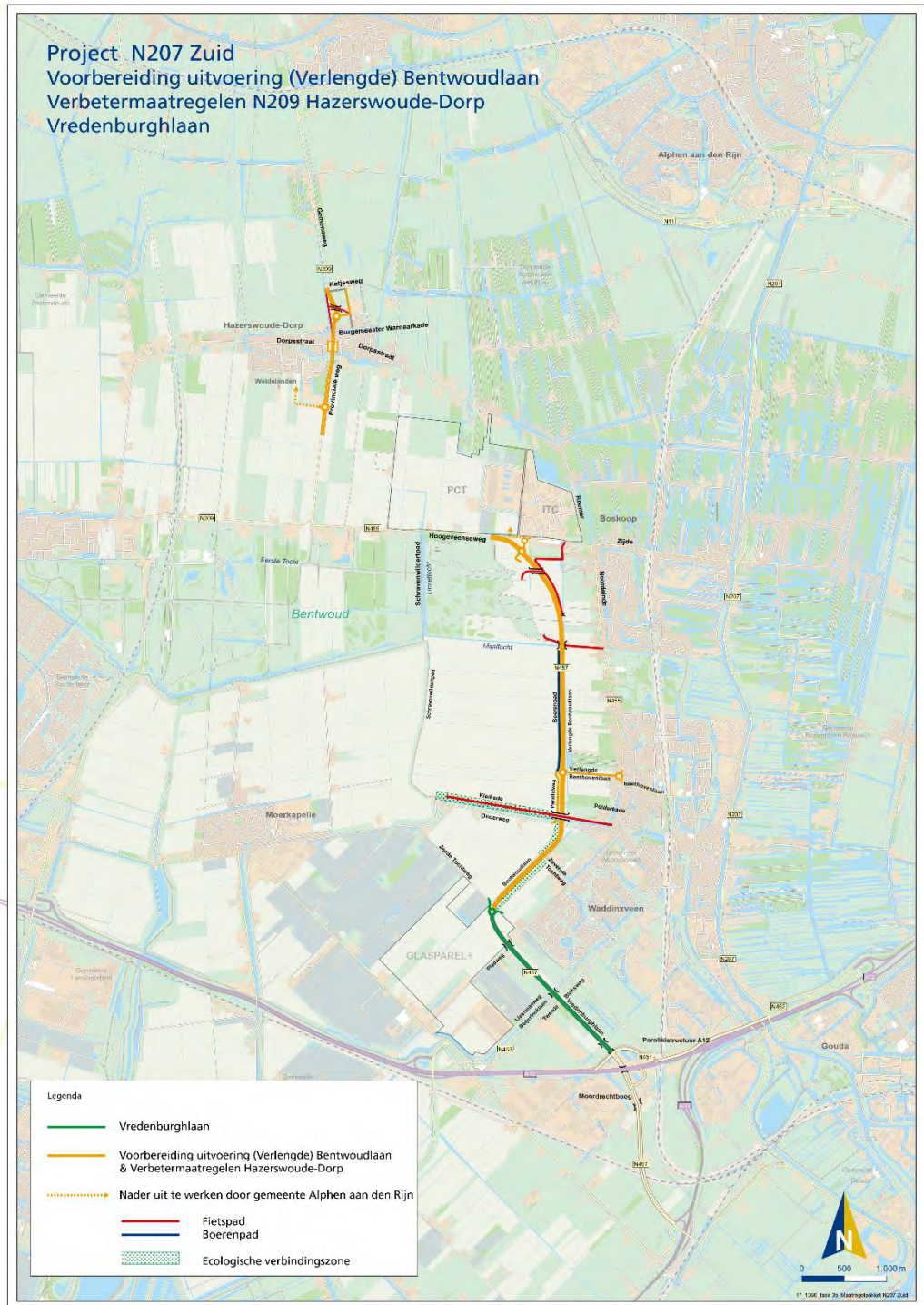
Figuur 1-1: De wegdelen Vredenburglaan, de Bentwoudlaan, de Verlengde Bentwoudlaan en Verlengde Beethovenlaan en de aanpassing van de verkeersstructuur in Hazerswoude-Dorp (N209) (allen in oranje afgebeeld, het project N207-Zuid) in het gebied weergegeven.
