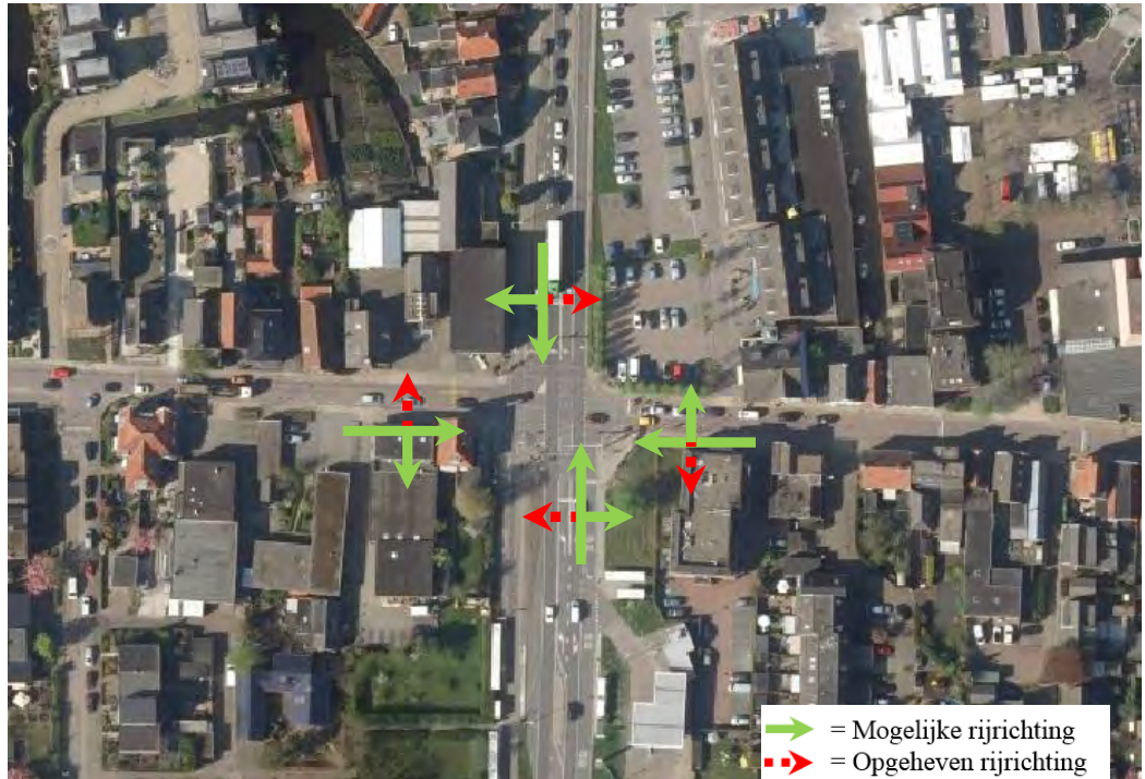
Figuur 9-12: Ontwerp kruispunt N209 - Dorpsstraat in variant X-Robuust, waarbij de linksafbeweging is opgeheven
