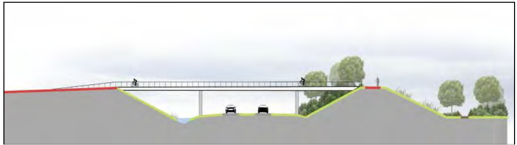
Figuur 8-3: Doorsnede van recreatieve passage over de Verlengde Bentwoudlaan heen
