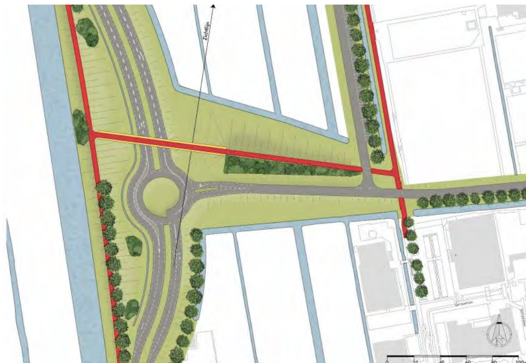
Figuur 9-14: Schets rotonde Noord en fietsnetwerk (rood) zonder benoemde verbindingweg in X-Robuust
