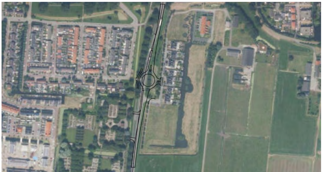
Figuur 9-9: Ontwerp (keer)rotonde Provincialeweg in variant X-Robuust
