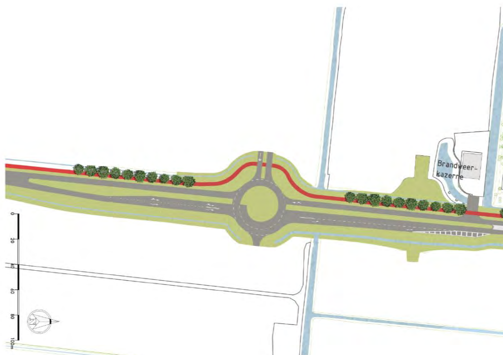
Figuur 9-16: Schets van rotonde Weidelanden ten zuiden van de Eerste Tocht
