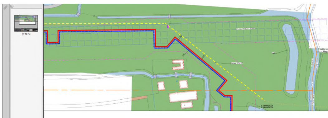
Afbeelding 10: In geel gestippeld de bestaande gasleiding, waar het tracé (rode en blauwe lijn) 5 m vandaan komt te liggen (bron: opdrachtgever).
