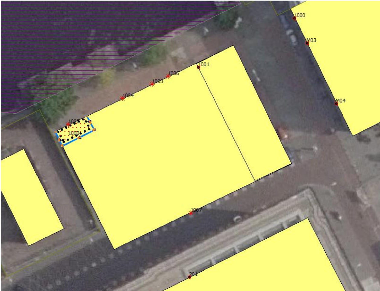
Figuur 2-3: De nieuwe woontoren inclusief de verwachte geluidbronnen van de WOS-installaties in het rekenmodel.
