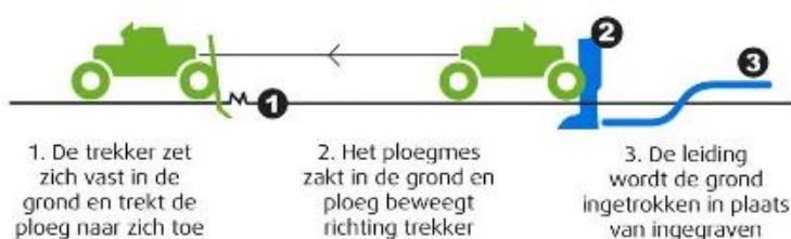
Figuur 3-3 Schematische weergave inploegen (Gasunie)
