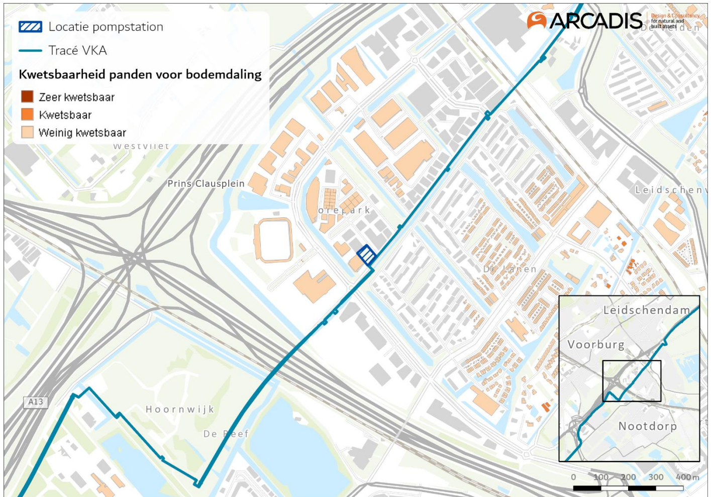
Figuur 11-5 Kwetsbaarheid panden voor bodemdaling rondom het pompstation (Bron: Provincie Zuid Holland – klimaatatlas)
