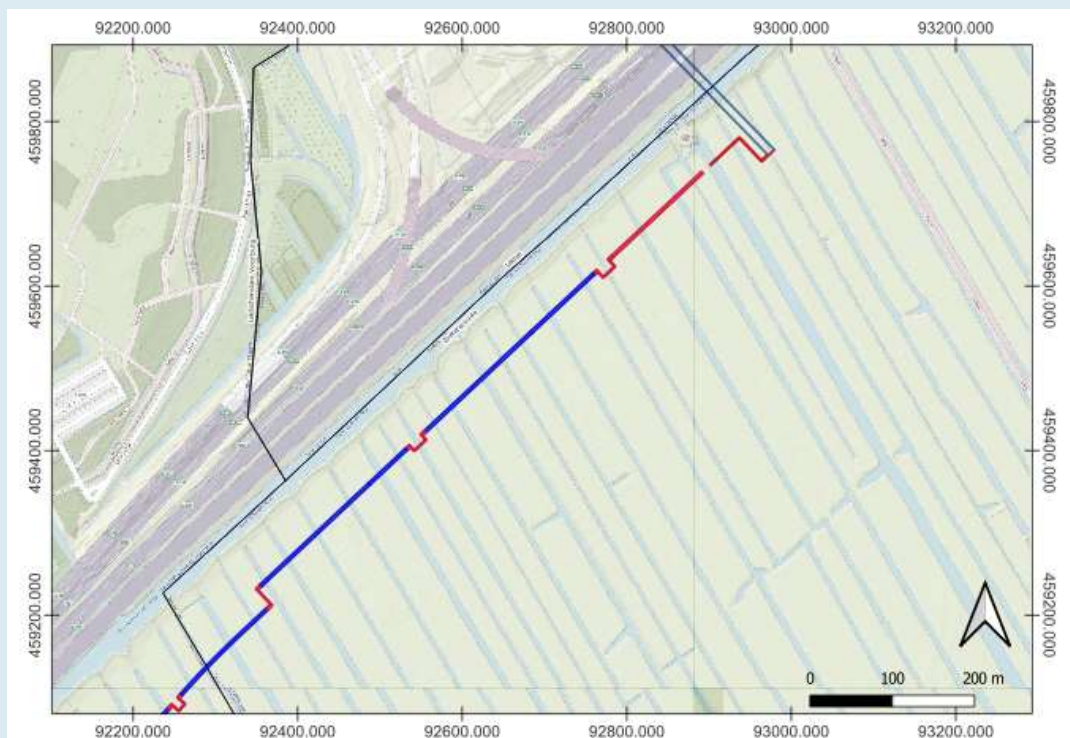
Abbeelding 1. Uitsnede topografische kaart met de ligging van het plangebied in de gemeente Zoeterwoude. Aanleg door middel van open ontgraving = rode lijn, aanleg door middel van sleufloze technieken = blauwe lijn.
