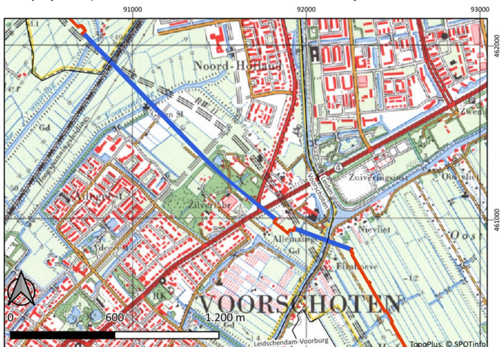
Afbeelding 13. Het plangebied op de topografische kaart van 1980. Aanleg door middel van open ontgraving = rode lijn, aanleg door middel van sleufloze technieken = blauwe lijn. (bron: www.topotijdreis.nl ).
