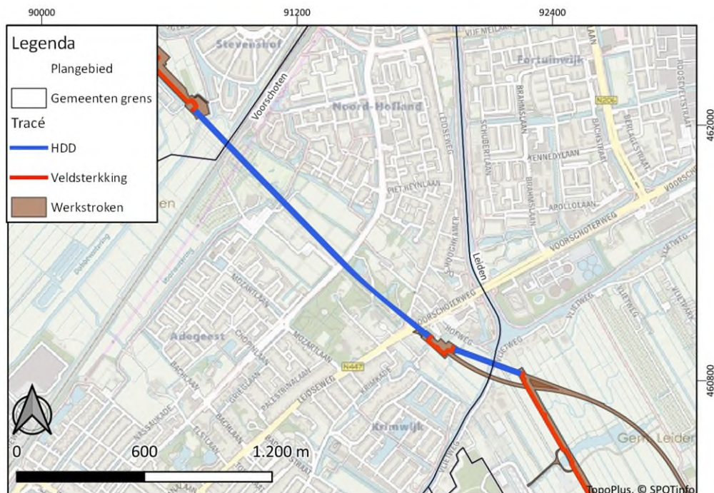
Afbeelding 3. Uitsnede topografische kaart met de ligging van het plangebied in de gemeente Voorschoten. Open ontgraving, rode en blauwe lijn, werkstrook bruin. Aanleg door middel van open ontgraving = rode lijn, aanleg door middel van sleufloze technieken = blauwe lijn.
