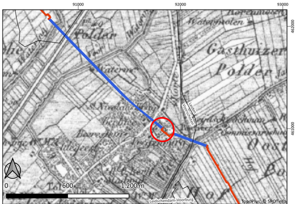
Afbeelding 12. Het plangebied op de topografische kaart van 1850. Aanleg door middel van open ontgraving = rode lijn, aanleg door middel van sleufloze technieken = blauwe lijn. (bron: www.topotijdreis.nl ). De locatie van de hofstede Vredenhoef is rood omlijnd.
