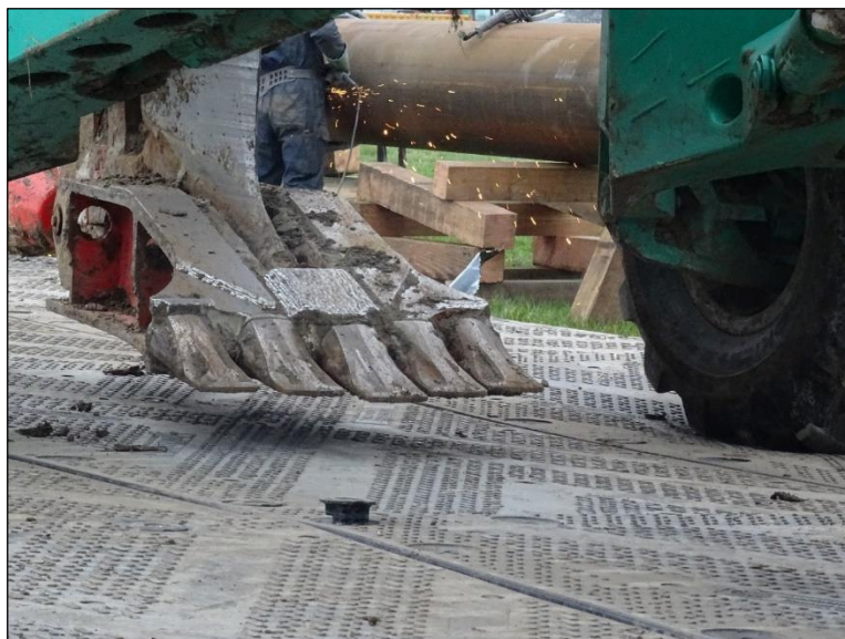
Figuur 3-3: Detail opname ripper shoe, tevens is onderste deel zwaard te zien (bron: Deltares, Inploegen grote diameter Leidingen).
