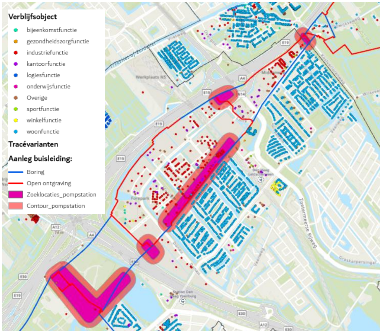
Figuur 12-17 Zoeklocaties pompstation met geluidscontour in gebruiksfase
