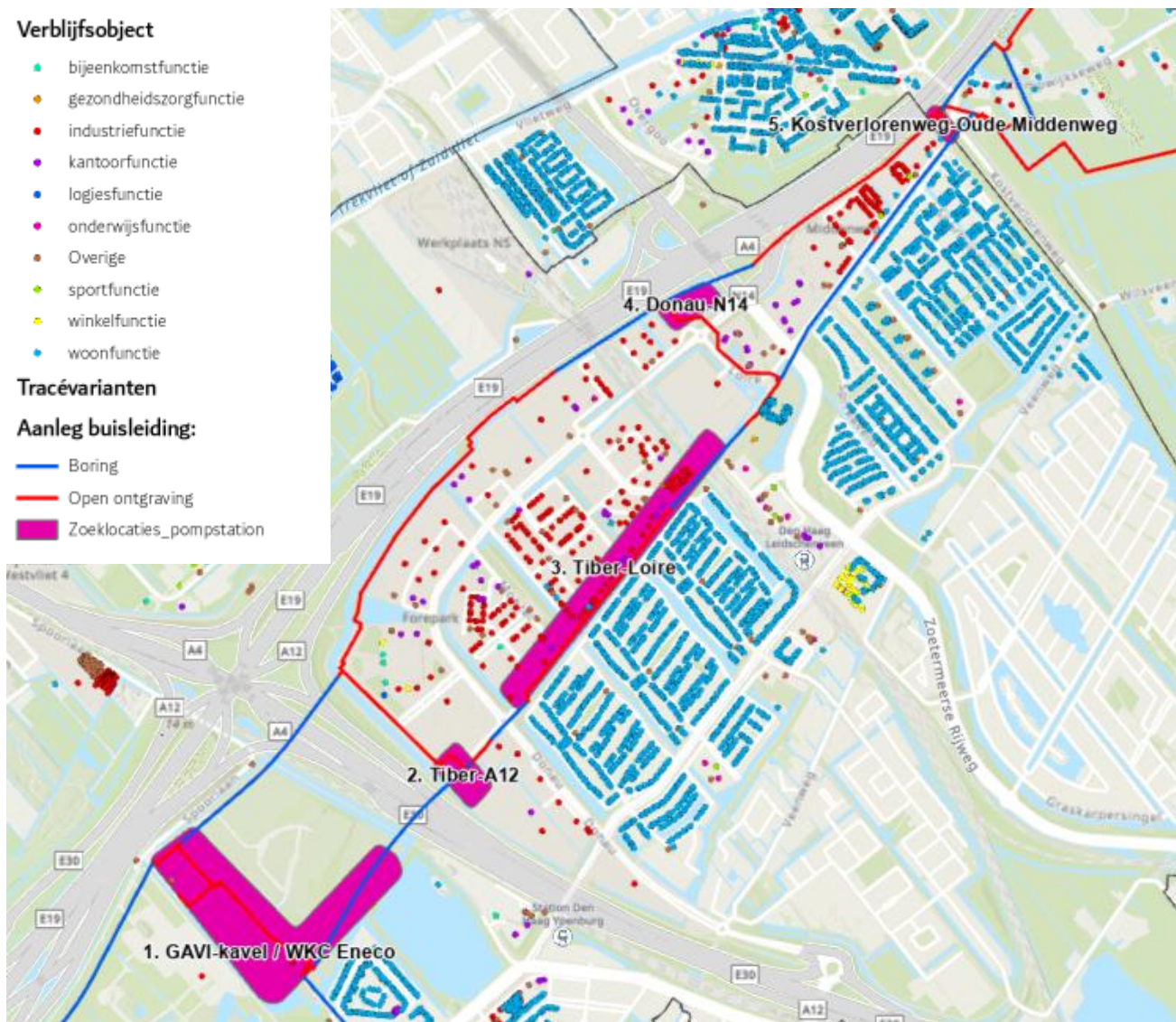
Figuur 12-16 Zoeklocaties pompstation met omliggende verblijfsobjecten
