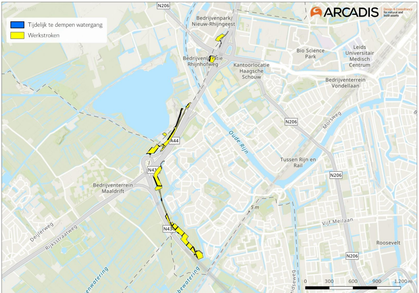
Figuur 5-3 | Tijdelijk te dempen watergangen in het noordelijk deel van het tracé.
