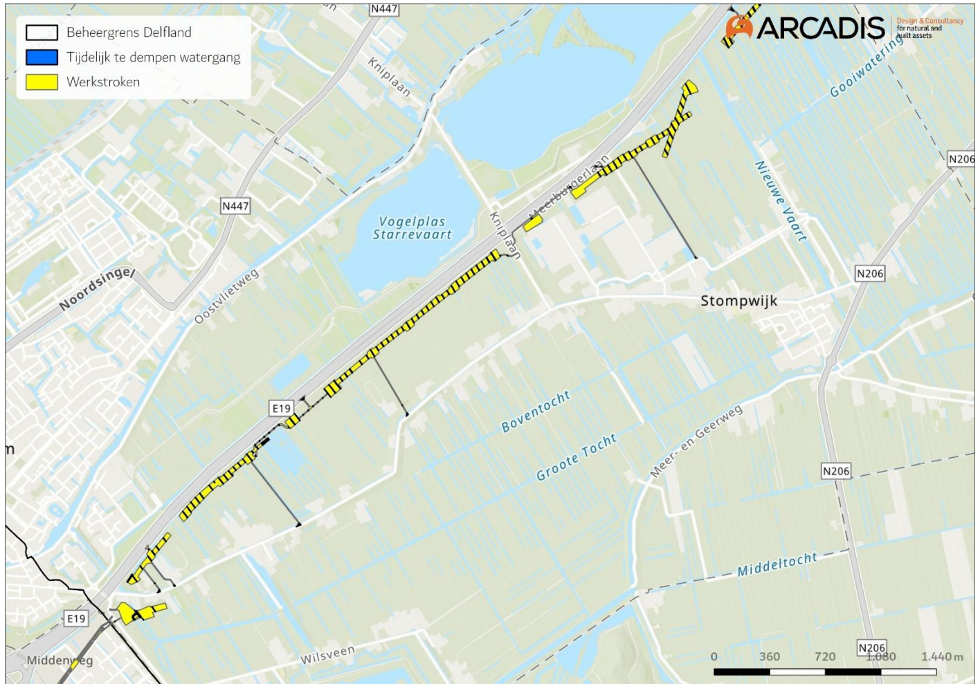
Figuur 5-1 | Tijdelijk te dempen watergangen in het zuidelijk deel van het tracé.
